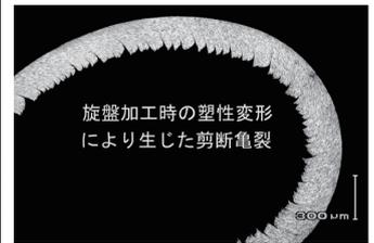
旋盤加工の切粉断面組
